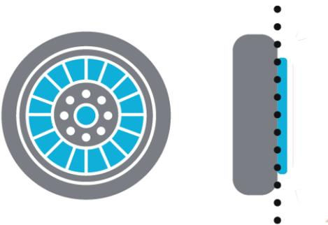
Bei überstehendem Felgenkranz können Beschädigungen auftreten.
